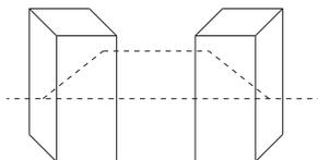
On pourrait penser qu'on obtient des polarisations soit horizontales soit verticales. Mais si on met à la fin du dispositif un filtre de même angle  $\theta$  que la lumière incidente, il laisse passer avec une probabilité 1, ce qui signifie que la lumière sortante a aussi une polarisation  $\theta$ . Si elle s'était divisée en photons horizontaux et verticaux, il aurait filtré avec une probabilité  $\cos^4(\theta) + \sin^4(\theta)$ .
