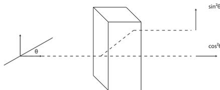
*Un faisceau de polarisation  $\theta$  passe en horizontal avec une probabilité de  $\cos^2(\theta)$  et est dévié avec une probabilité de  $\sin^2(\theta)$ .*
