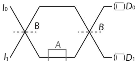
$I_0$  et  $I_1$  sont des sources de photons. En  $B$  se trouvent des miroirs semi-réfléchissants (*beam splitter*) qui laissent passer un photon ou le réfléchissent avec une probabilité  $1/2$ .  $D_0$  et  $D_1$  sont des détecteurs de photons.
